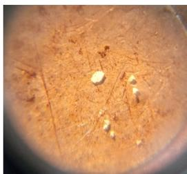
**Figura 7.** Muestra del producto obtenido en la metodología 2 sobre el cubreobjetos para medición del punto de fusión en el equipo Fischer.
