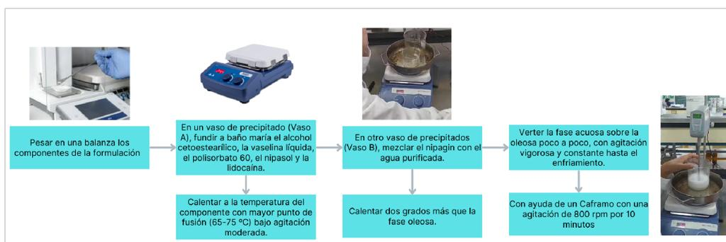
**Figura 1.** Diagrama de elaboración de emulsiones, ilustra el proceso de mezcla de dos líquidos inmiscibles para formar emulsiones estables.
