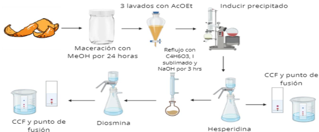
**Figura 1.** Esquema gráfico Diagrama de la metodología empleada para la extracción de hesperidina a partir de la cáscara de naranja y posterior síntesis de diosmina.
