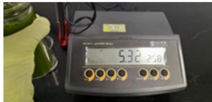
**Figura 3:** Determinación potenciométrica del pH de la savia.
