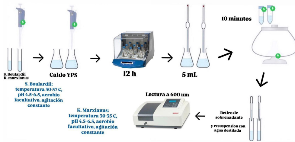
Figura 2. Proceso y condiciones de fermentación.
