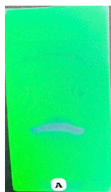
Figura 3. Cromatografía de Naproxeno extraído de tabletas comerciales de Naproxeno.
