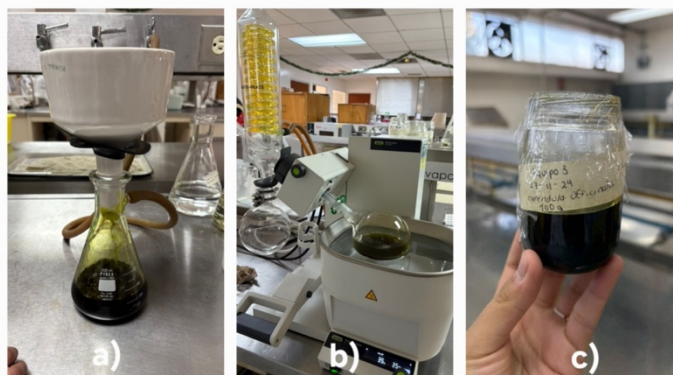
Figura 2. Obtención del extracto de caléndula A) Filtración del extracto de caléndula, B) Concentración en rotavapor, C) Volumen final de extracto líquido.
