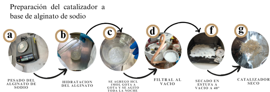
Figura 2. Preparación del catalizador verde.
