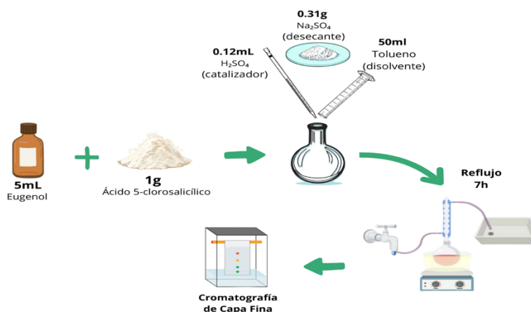
Esquema 1. Proceso para la fase experimental.
