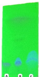
Figura 4. Cromatografía de Naproxeno, reacción y ácido salicílico.
